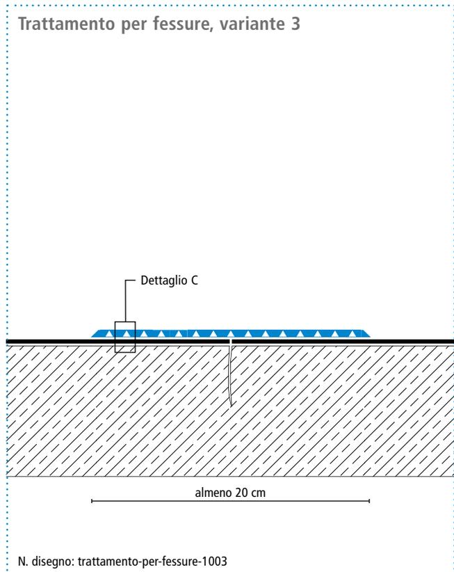
Struttura del sistema – Dettaglio C
