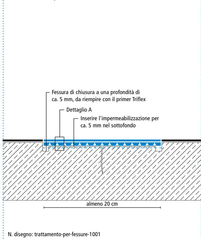
Struttura del sistema – Dettaglio A
