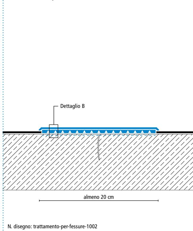
Struttura del sistema – Dettaglio B
