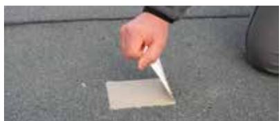
**In Anlehnung an die Schweizer Norm SN 564 281/2 wird der Haftzugtest von Hand wie folgt durchgeführt:**
