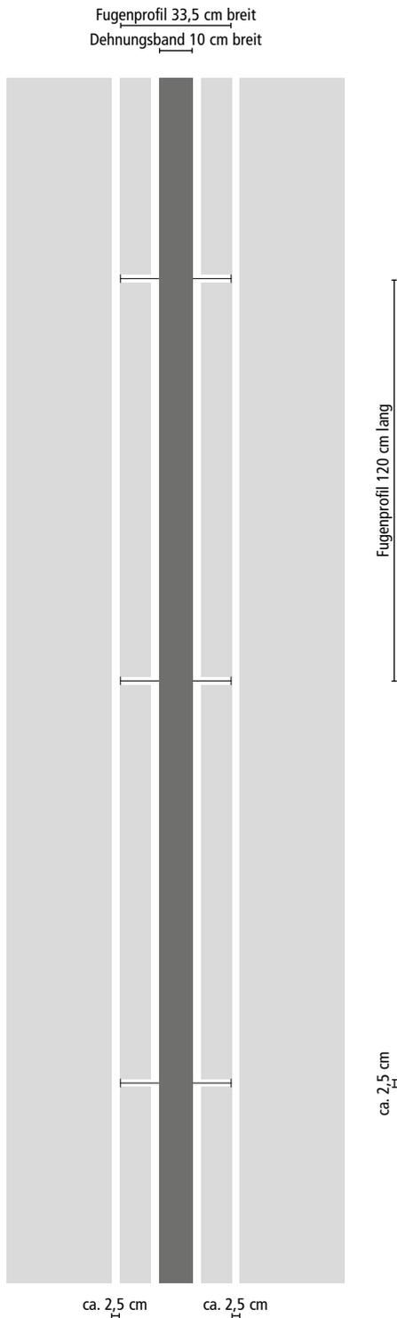
Im Bereich der Stöße des Fugenprofils wird das Oberflächenschutzsystem ca. 2,5 cm breit ausgespart.
