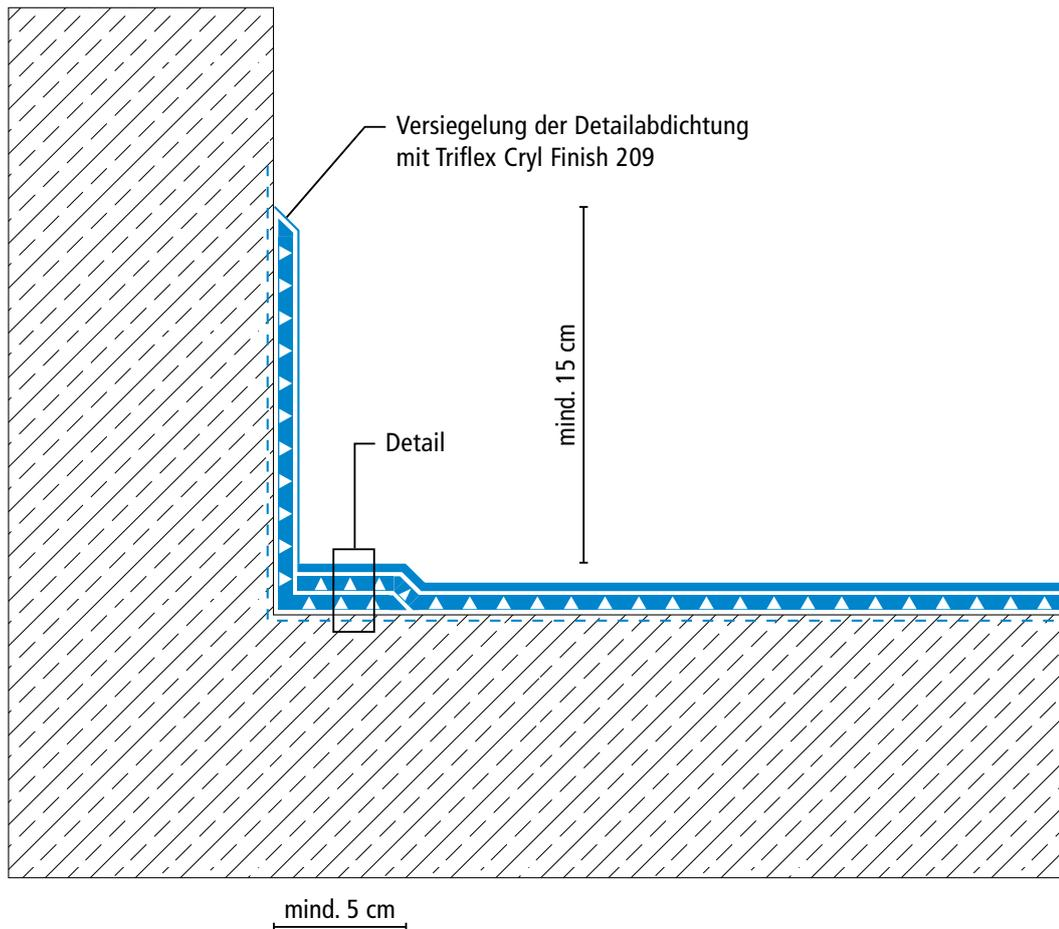
\* Waagerechte Detailabdichtungen (z. B. Arbeitsfugen) können mit Triflex ProDetail oder Triflex ProPark ausgeführt werden.
