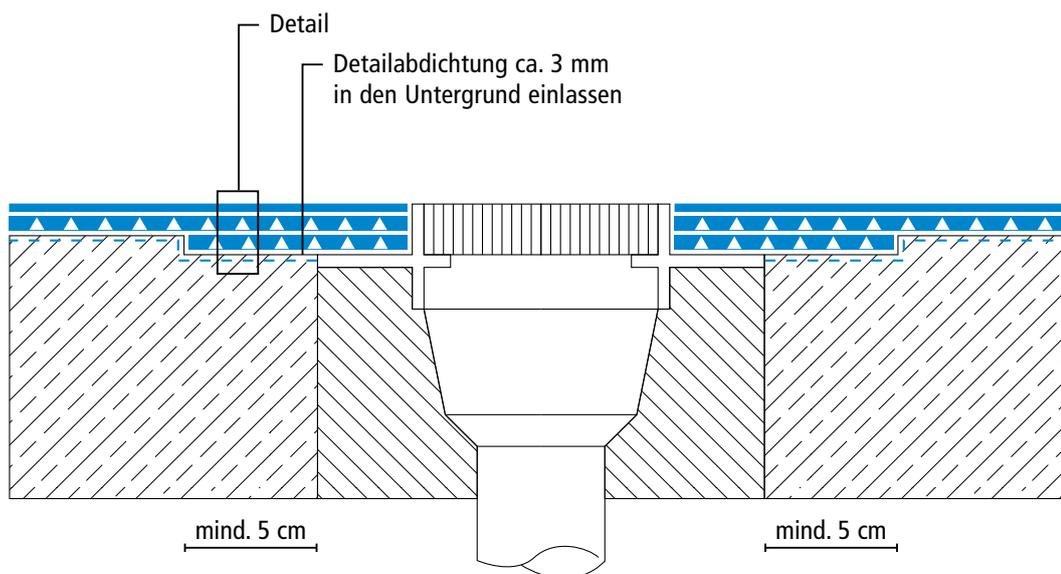
\* Waagerechte Detailabdichtungen (z. B. Arbeitsfugen) können mit Triflex ProDetail oder Triflex ProPark ausgeführt werden.
