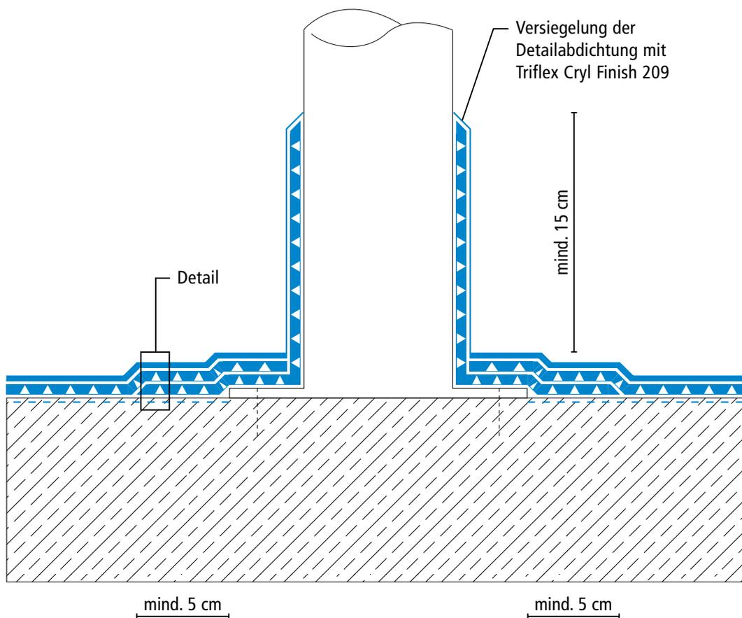
\* Waagerechte Detailabdichtungen (z. B. Arbeitsfugen) können mit Triflex ProDetail oder Triflex ProPark ausgeführt werden.
