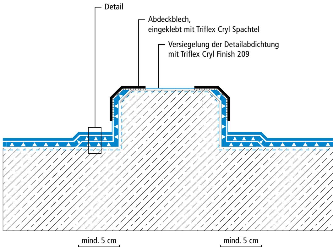
\* Waagerechte Detailabdichtungen (z. B. Arbeitsfugen) können mit Triflex ProDetail oder Triflex ProPark ausgeführt werden.
