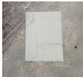
Die am Autohaus Meyer entnommenen Testkörper wurden eingehend untersucht und in sehr gutem Zustand befunden. In Kombination mit einer erweiterten ETA-Prüfung wird Triflex ProDetail nun eine verlängerte Nutzungsdauer von zu erwartenden 40 Jahren bescheinigt.
